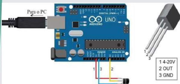
Figura 2: Ilustração das conexões do sensor de temperatura LM53 (mostrado em destaque à direita) ao Arduino.
